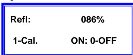
Apriete tecla 1 para recalibrar utilizando la muestra de prueba abajo del ANALYZER. La tecla 0 enciende y apaga la lectura del PCS.
