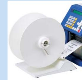
Con el rebobinador interno, que viene de serie con la impresora, podrá rebobinar rollos de etiquetas hasta un diámetro de 100 mm. Con la opción de dispensado, este rebobinador interno puede emplearse para rebobinar el papel soporte de la etiqueta. Con el rebobinar externo PR45s (vea la ilustración) se pueden rebobinar rollos de etiquetas de hasta 270 mm. Tiene ambas direcciones de rebobinado.
