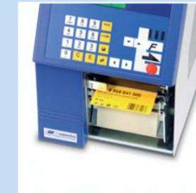
La unidad de dispensado separa la etiqueta del papel soporte y la expide para su posterior aplicación. Después de quitar la etiqueta, se activa la siguiente orden de impresión, bien mediante una fotocélula o bien mediante un impulso externo.
